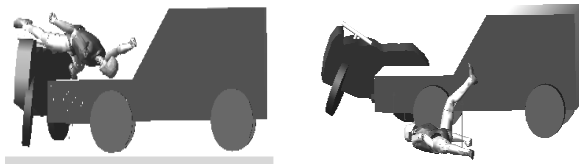
Fig. 2 : 90 degrees side impact
